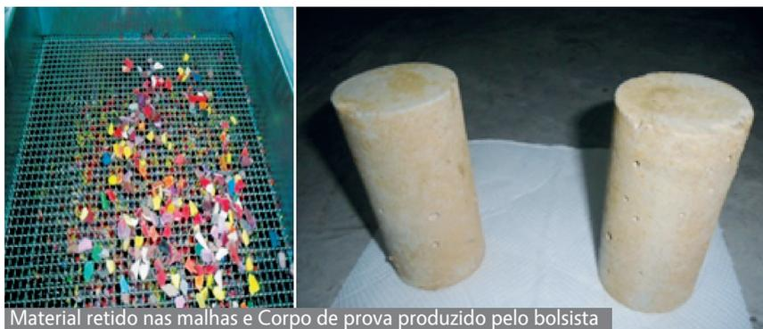
Material retido nas malhas e Corpo de prova produzido pelo bolsista
