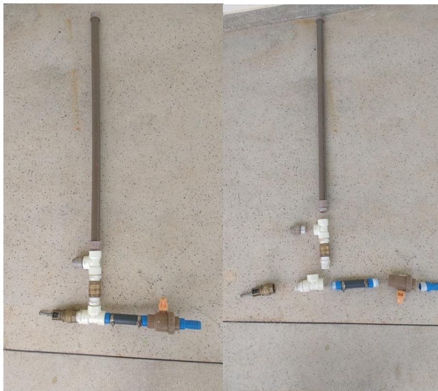
Figura 11 – Carneiro hidráulico artesanal. Fotos: acervo próprio.
