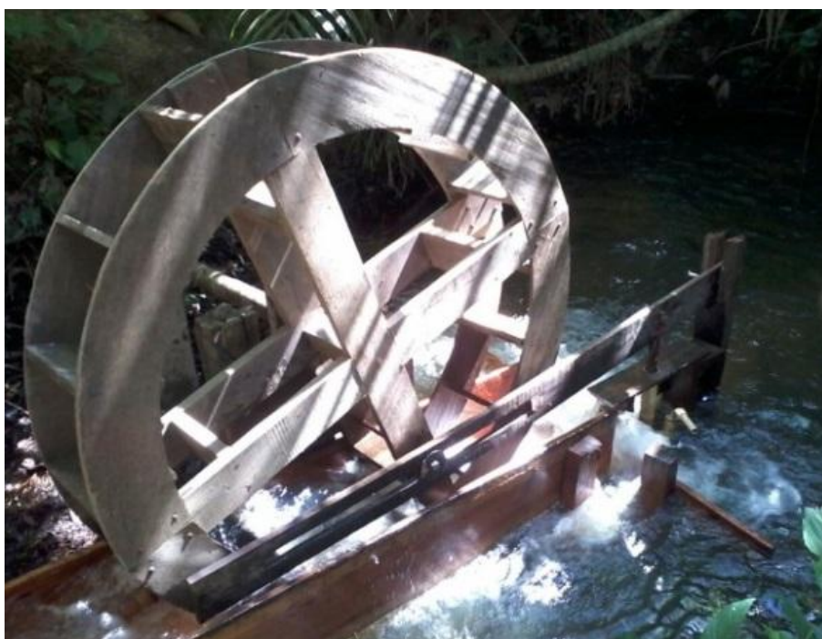
Figura 14 – Roda d'água tipo subaxial. Acervo IFPA\CRMB.
