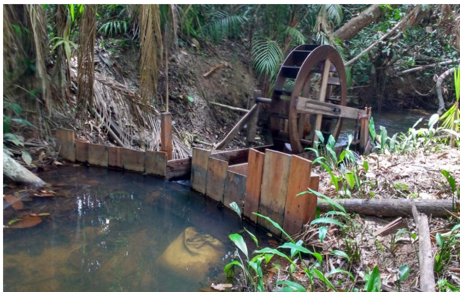
Figura 9 – Roda d’água subaxial instalada no lote 50 PA 26 de Março. Foto: Acervo IFPA/CRMB.
