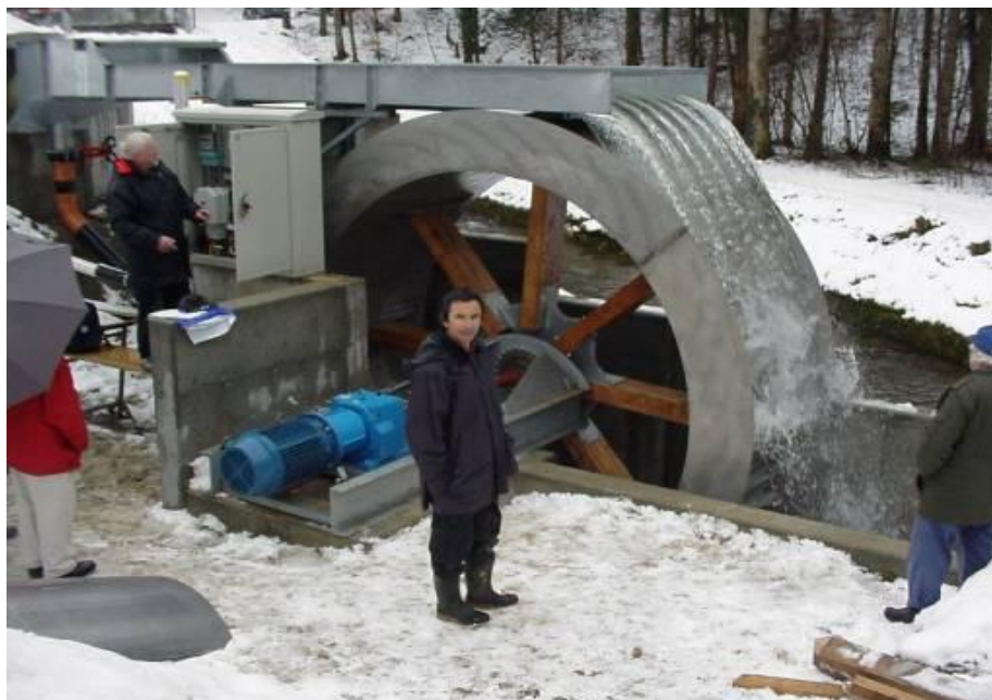
Figura 13 – Roda d'água tipo sobreaxial. Fontes: Alterima (2011)
