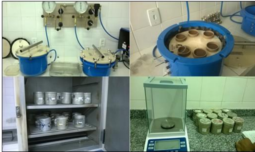
Figura 6 - Aparato para determinação da capacidade de campo e ponto de murchamento do solo. (Fonte: Albuquerque & Magalhães, 2016 )
