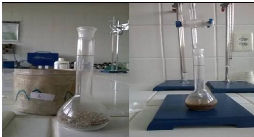
Figura 5 - Método do balão volumétrico para determinação da densidade de partículas do solo. (Fonte: Albuquerque & Magalhães, 2016)
