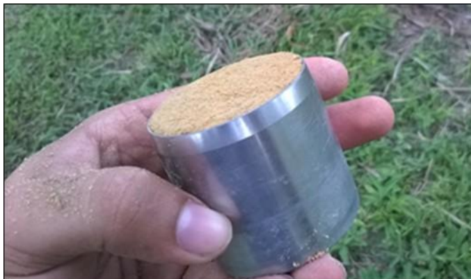
Figura 4 - Amostra indeformada para determinação da densidade do solo. (Fonte: Albuquerque & Magalhães, 2016)
