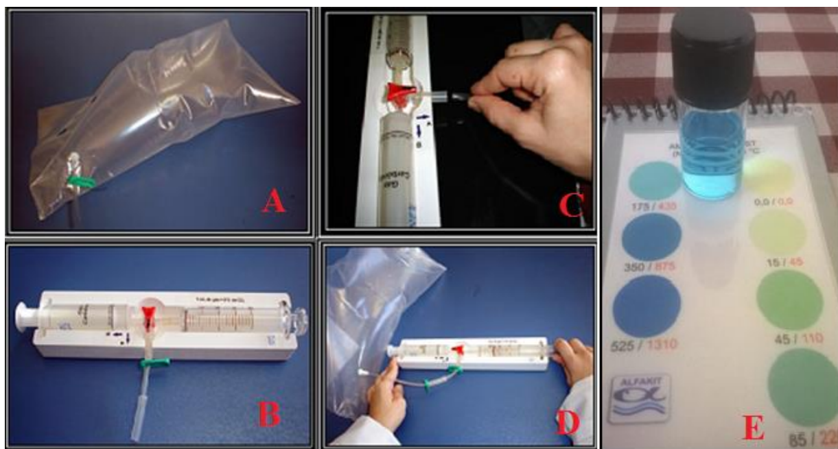
Figura 2.6: Coleta do biogás e análise química (A: Saco amostrador, com biogás; B: Suporte e seringa analisador de CO 2 ; C e D: Procedimento de análise de CO 2 e E: Procedimento de análise da Amônia e do Gás Sulfídrico).
