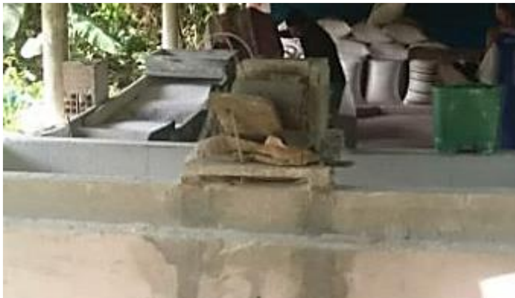
Figura 16. Equipamento utilizado para cervar a fécula hidratada
