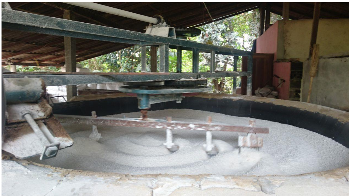
Figura 19. Etapa de escaldamento em forno mecânico
