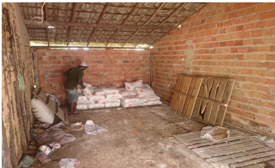
Figura 5. Armazenamento de fécula em contato com paredes
