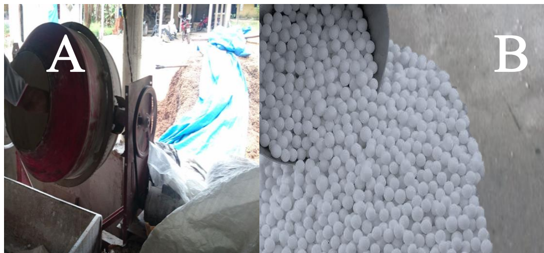
Figura 17. Encaroçamento, A: manipulador operando a betoneira para o encaroçamento da massa; B: Fécula encaroçada
