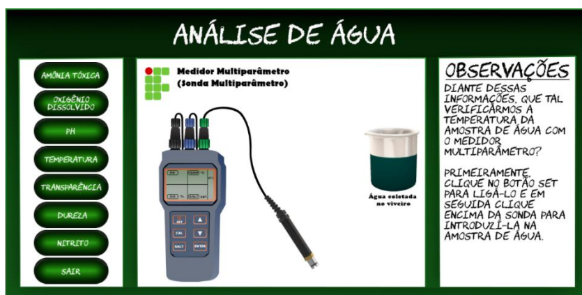
Figura 40 – Medição de temperatura por sonda multiparâmetro
