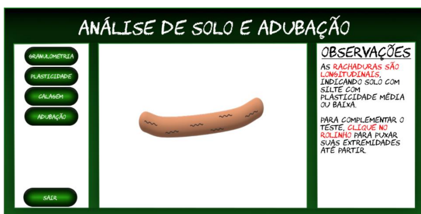
Figura 54 – Rolinho com rachaduras longitudinais
