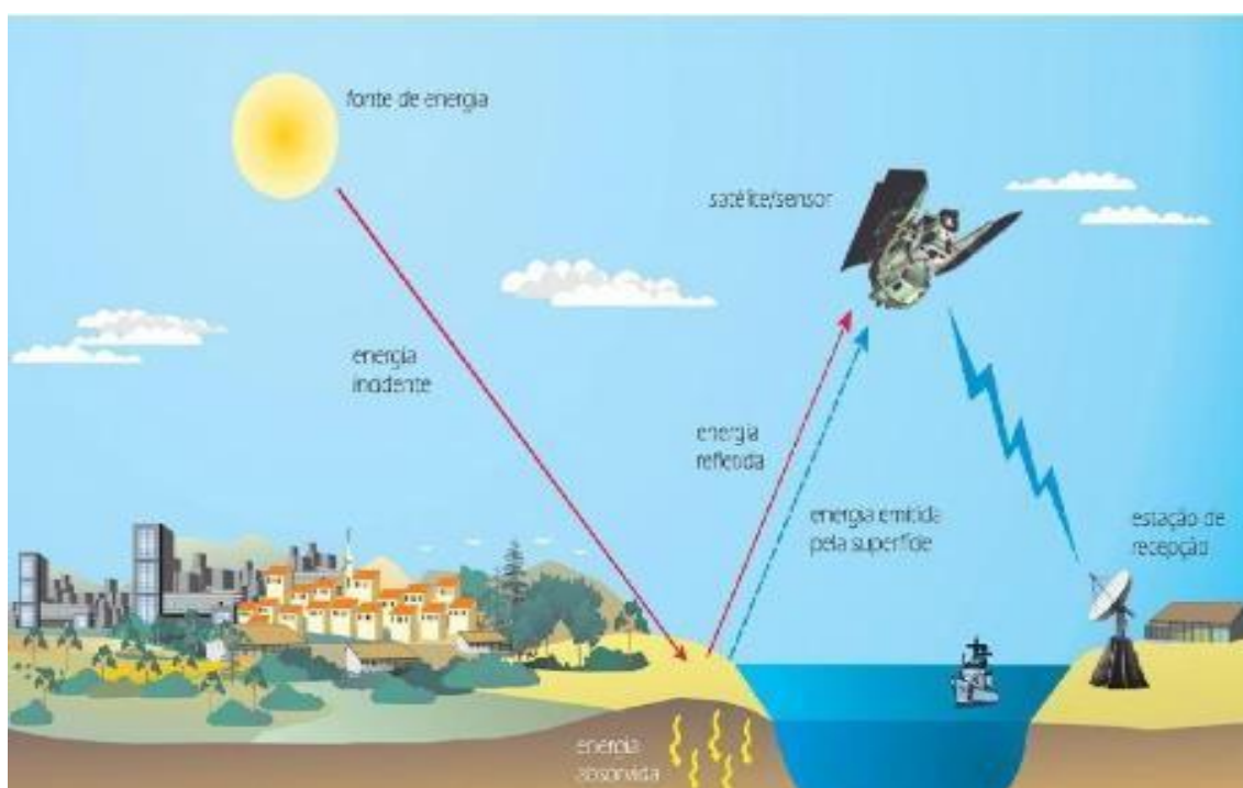
Figura 3: Ilustração de obtenção de imagens por sensoriamento remoto.
