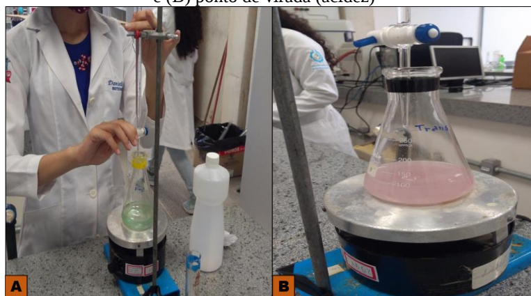
Figura 2 - Análise de acidez: (A) titulação da solução com KOH e (B) ponto de virada (acidez)
