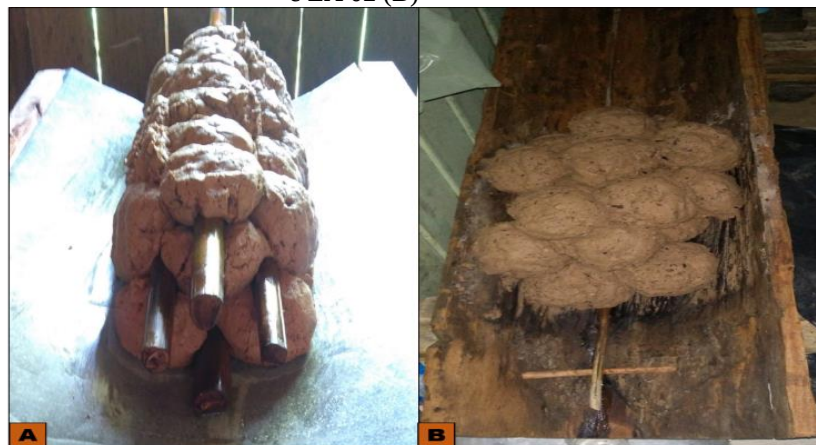
Figura 22 - Molde da massa e hastes utilizada para facilitar o escoamento do óleo: EA 01(A) e EA 02 (B)
