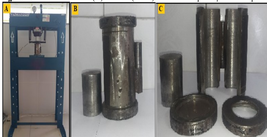
Figura 18. Prensa hidráulica (A) e molde (B e C) utilizados na produção dos briquetes.
