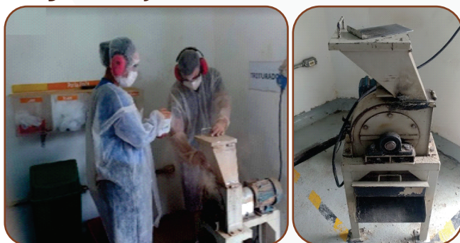
Fig. 2: Moagem das Biomassas / Moedor
