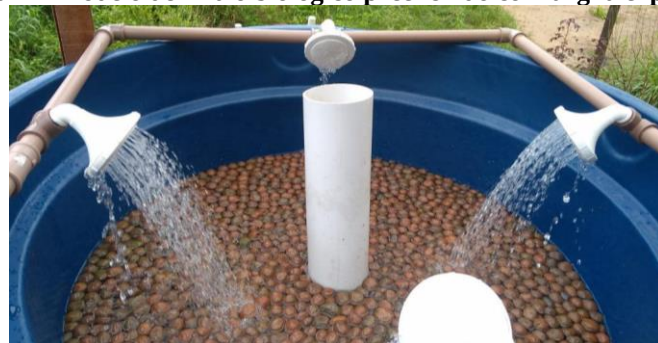
Figura 4 – Modelo de Filtro biológico preenchido com argila expandida
