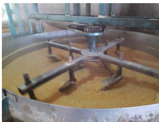
Figura 13: Escalda em forno mecânico.
