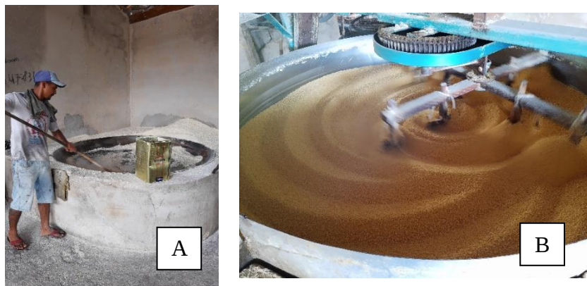
Figura 14: Torra da farinha a) forno manual b) forno mecânico.
