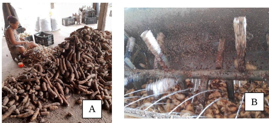
Figura 9: Descasque da mandioca a) manual b) mecânico.
