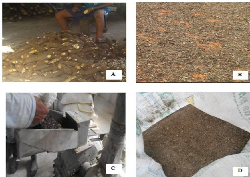
Figura- Preparação da casca da mandioca. Legenda. A- Descascamento manual da mandioca para elaboração da farinha. B- Casca da mandioca colocada em lona plástica para secagem. C- Trituração da casca em máquina forrageira. D- Farelo da casca da mandioca pronto.
