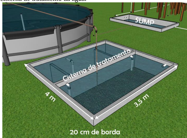
Figura 5 – Dimensões cisterna de tratamento da água.
