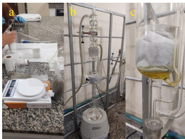
Figura 4 – Procedimento de tratamento químico usando o extrator Soxhlet
